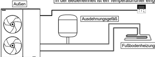
Fußbodenheizung oder Heizkörper direkt an das Außengerät anschließen.
