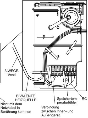
Führen Sie die Kabel wie in der Abbildung oben gezeigt.
