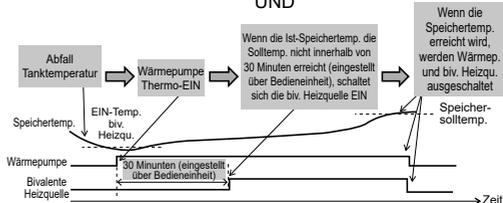
Bivalente Heizquelle Im Erweiterten Parallelbetrieb ist eine getrennte Einstellung für Pufferspeicher und Warmwasserspeicher möglich. Während des Heiz- und Warmwasserbetriebs („HEAT+TANK“) wird der Bivalenzausgang bei jeder Umschaltung der Betriebsart auf AUS zurückgesetzt. Für die Auswahl der optimalen Einstellung für das System ist ein gutes Verständnis der der Bivalenzfunktion erforderlich.
