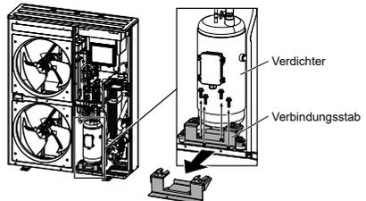
So entfernen Sie den Verbindungsstab
