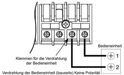
Verdrahtung der Bedieneinheit (bauselts) Keine Polarität
