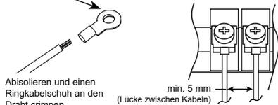
Abisolieren und einen Ringkabelschuh an den Draht crimpen
