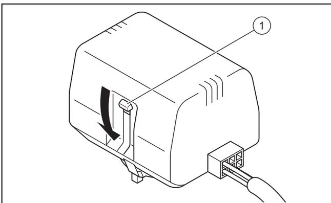
3. Drücken Sie den weißen Umschalthebel (1) am Motorkopf des Umschaltventils bis zum Einrasten in seine
