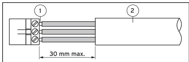
1 Anschlussdrähte 2 Isolierung
