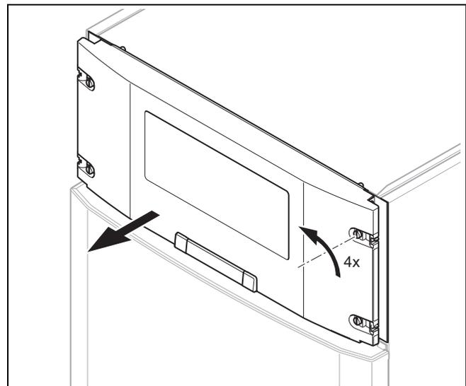
2. Drehen Sie die vier Schrauben jeweils um eine Vierteldrehung und ziehen Sie die Abdeckung des Bedienfelds nach vorn ab.
