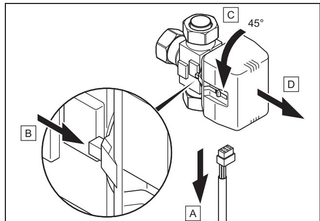
14. Ziehen Sie das Stromversorgungskabel am Motorkopf des Umschaltventils ab (A).
