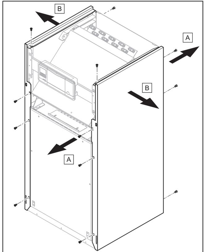
2. Drehen Sie 4 Schrauben vorn und 3 Schrauben hinten zur Demontage einer Seitenverkleidung heraus.
