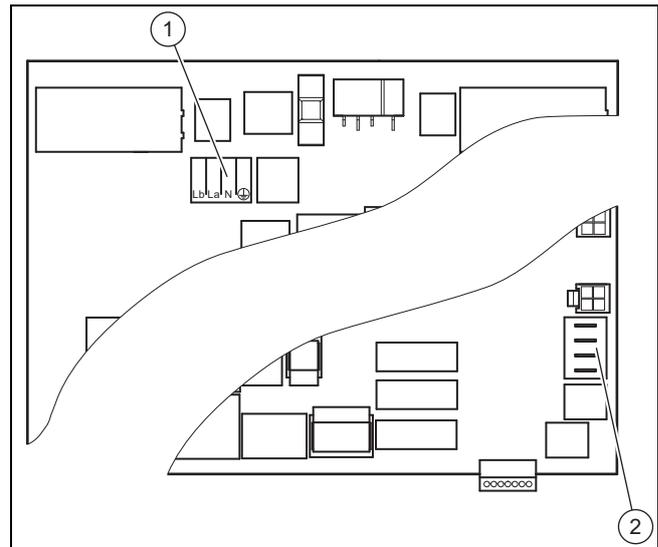
Für den Anschluss eines Trennrelais für die externe Brunnenpumpe steht ein Wechselkontaktanschluss X143 (1) mit der Belegung Lb, La, N, PE zur Verfügung.
