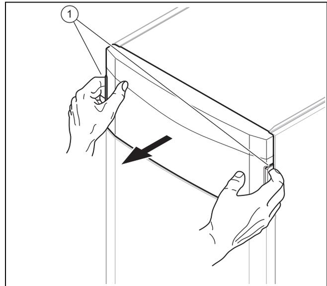
1. Demontieren die Frontklappe des Bedienfelds, indem Sie mit beiden Händen in die Griffmulden fassen und die Frontklappe nach vorn abziehen.
