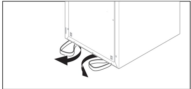
3. Schwenken Sie die unter dem Produkt befindlichen Trageschlaufen nach vorn.
