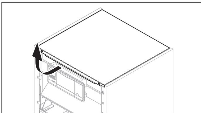
1. Ziehen Sie den Verkleidungsdeckel etwas nach vorn und heben Sie ihn nach oben ab.
