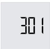
▶ Drücken Sie länger als 3 s die Taste „Menü“. Die Software-Versionsnummer der Reglerelektronik erscheint.
