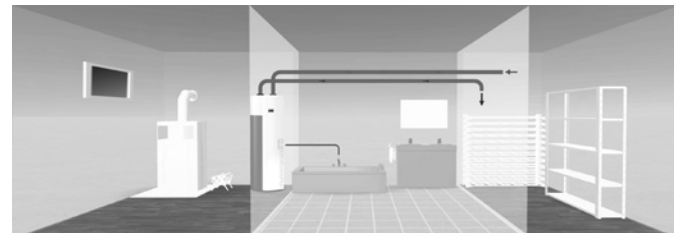
Kühlung des Vorratsraumes
